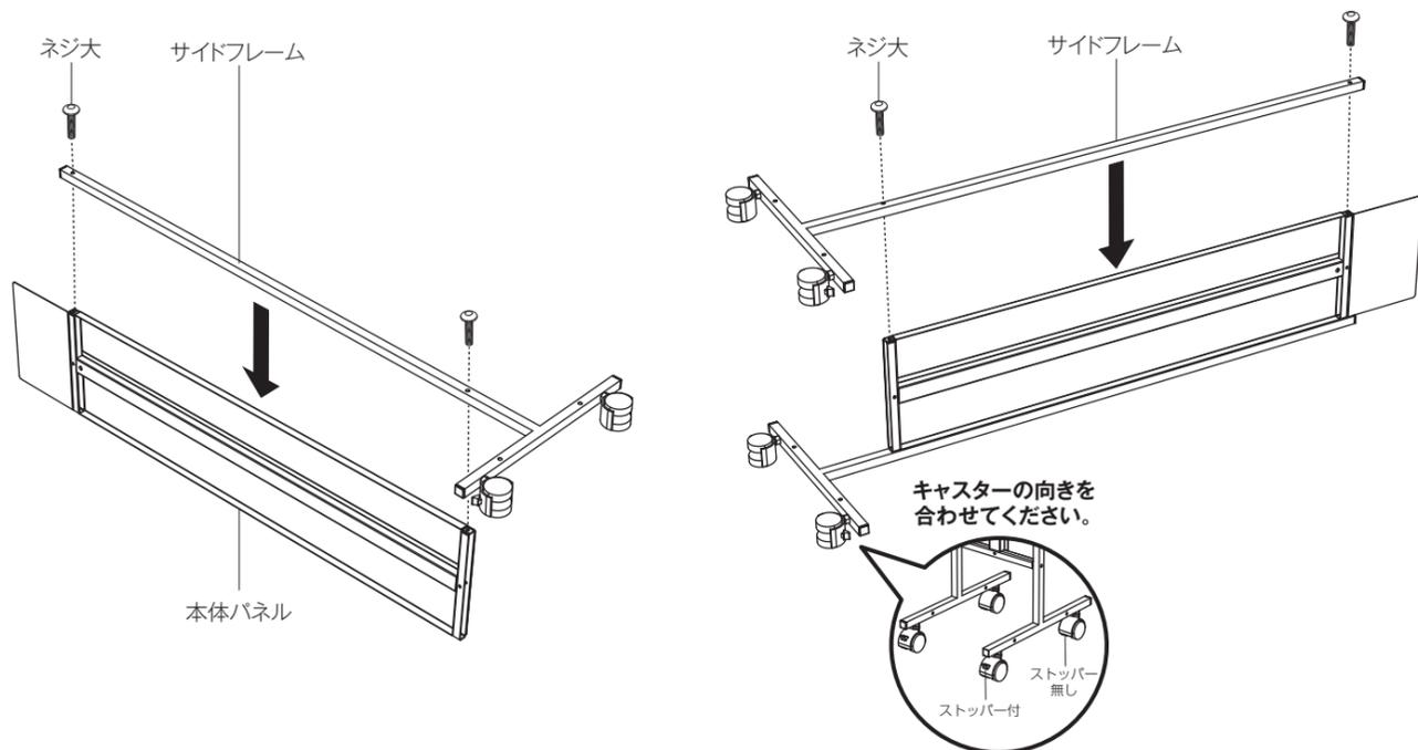
**③ 補強パイプを取り付けてネジ大で締め付けて**
