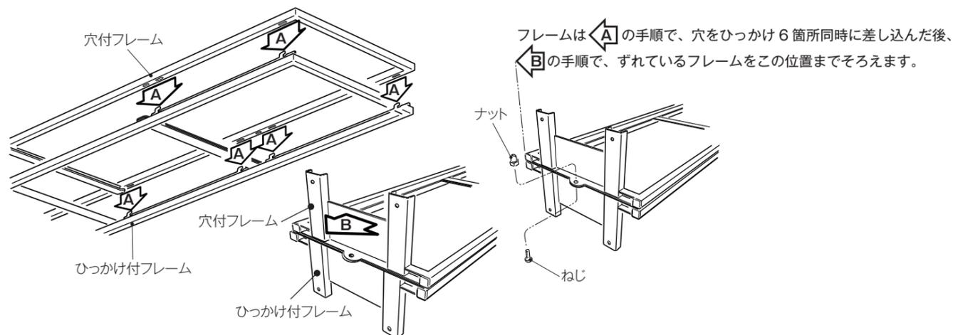
③ フレームに底板の穴位置を合わせ、ねじとナットで仮組後、4箇所(のねじとナットをドライバーとスパナで本締めしてから、底板に底板カバーの穴位置を合わせ、ねじ(2箇所)で仮組後、ドライバーとスパナで全てのねじとナットを本締めしてください。
