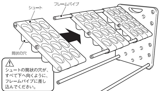
**3** 左サイドパネル内側 (TERAMOTO 刻印の無い面) の、穴があいたくぼみ (4箇所) を、フレームパイプ先端へ、奥までしっかり差し込みます。次に、両サイドパネル外側の穴があいたくぼみ (計8箇所) へ、平ワッシャを通したボタンボルトで、ガタつきがなくなるまでしっかり固定します。
